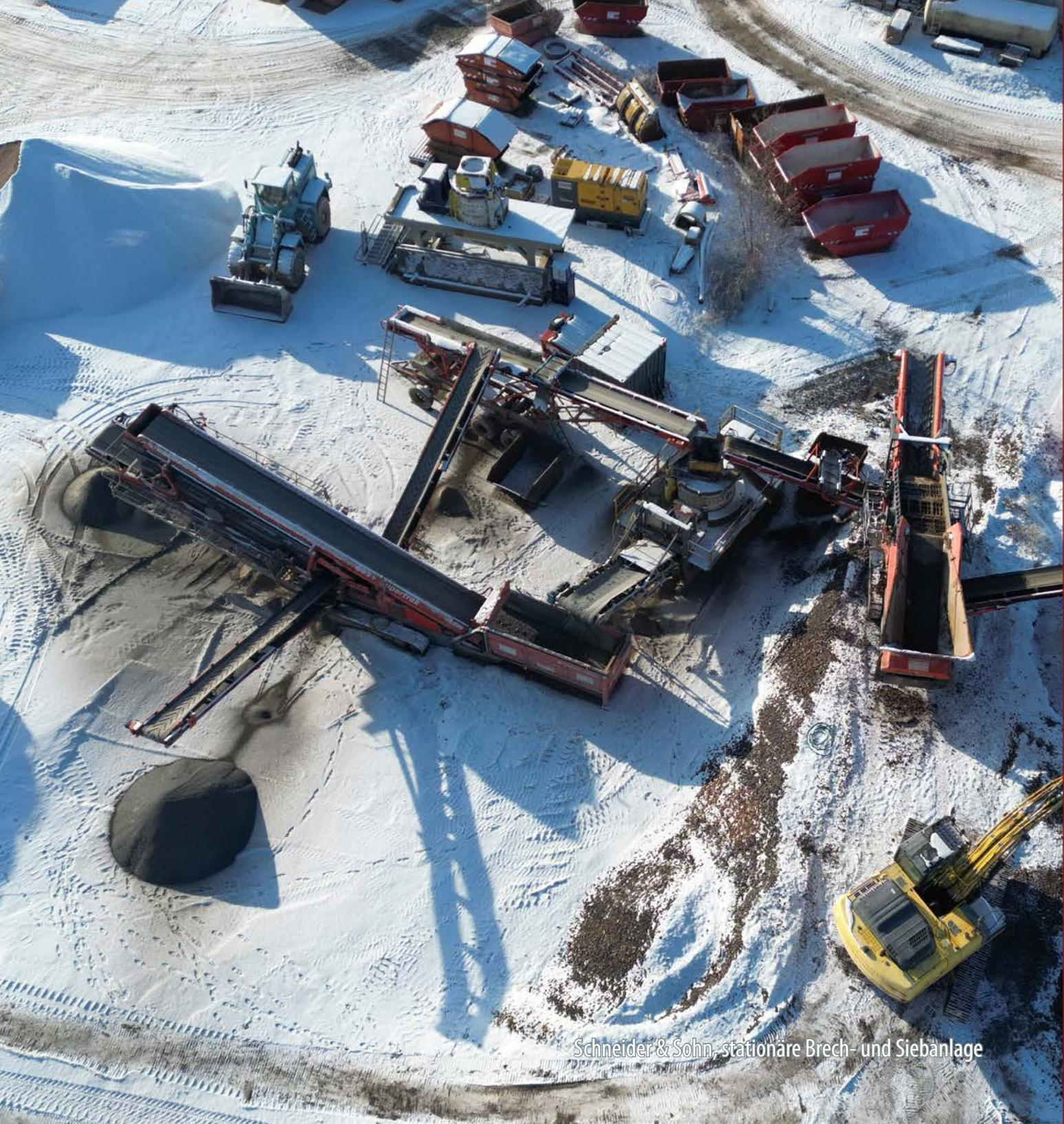
Schneider & Sohn, stationäre Brech- und Siebanlage
